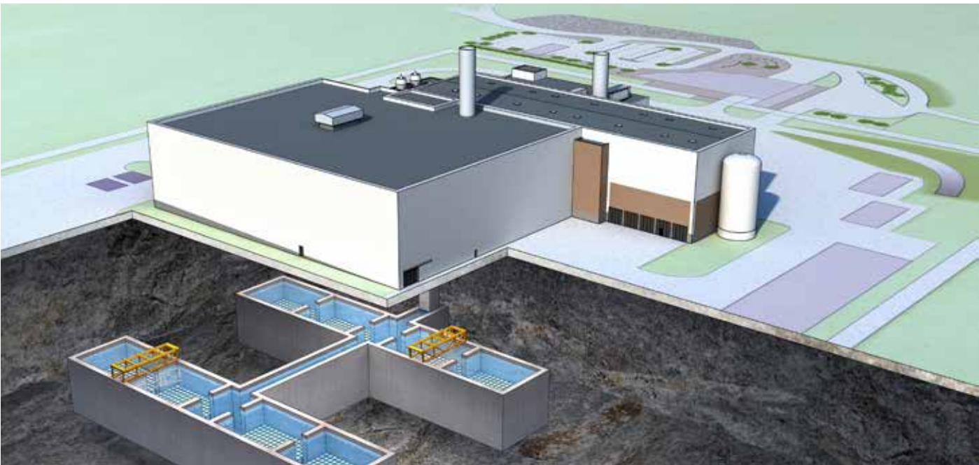
Schematisk bild över mellanlagret CLAB där kärnavfallet ska kylas ned till under 100 grader. Det kräver kontinuerlig tillgång på el för att inte anläggningen ska torrkoka och därmed orsaka en katastrof med spridning av radioaktivitet. Bild: SKB.
