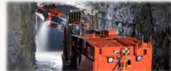
EnergyStorage tunnlar och långa borrhål produceras med fjärrstyrd gruvutrustning från svenska leverantörer
